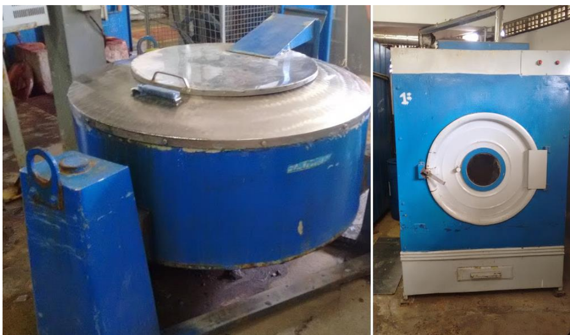
Figura 6. Máquinas para centrifugar e secar as amostras. Da esquerda para direita: extrator centrífugo pendular e secador rotativo, ambos da marca Automak.
